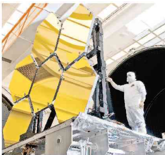
Il montaggio degli specchi del «James Webb Telescope»
